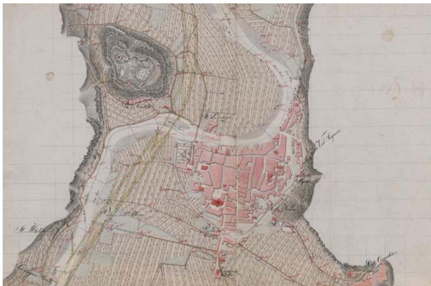
Fig. 7 - *Hydrologische-oeconomische Karte des Etsch-Thales sammt Profils und Niveauconten, weiters den eingezeichneten Arbeiten zur Regulierung dieses Flusses vom Schloss Tirol angefangen bis Besenello*, ing. Major von Nowack im Jahre 1805, Vienna, KAW, BIX b 149-30, nr. CXV.
