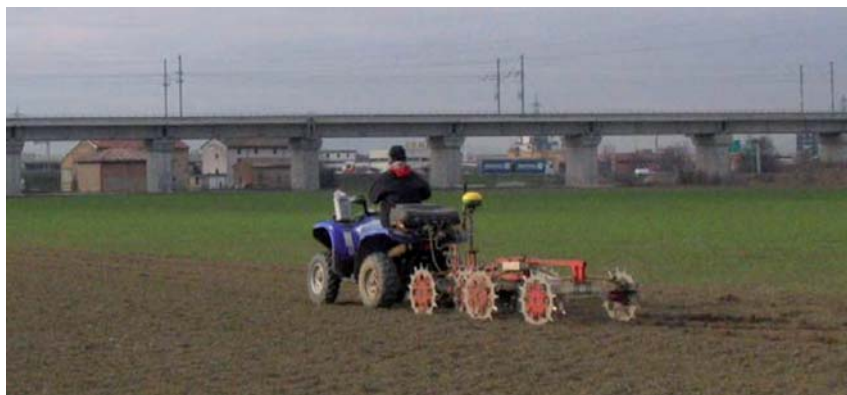
Fig. 6 - La misura della resistività apparente in continuo (dal sito www.geocarta.net ).
