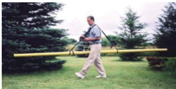
Fig. 9 - Uno strumento FDEM (dal sito internet: www.dualem.com/products.html ).
