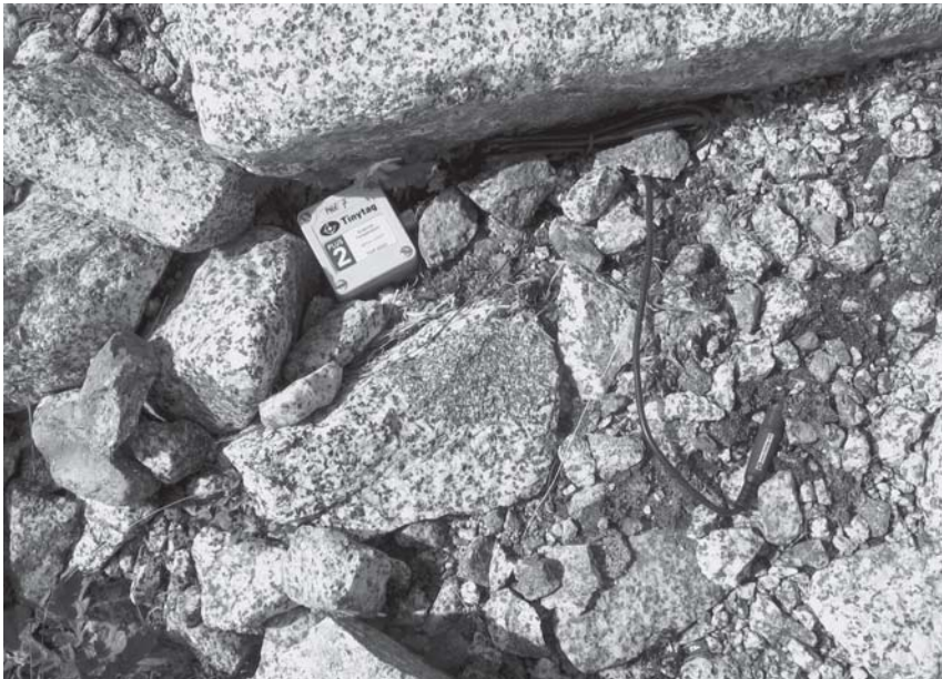
Fig. 5 - Data logger dotato di sonda termometrica esterna per la misura della temperatura della superficie del suolo durante il corso dell'anno.
