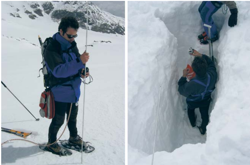
Fig. 1. Misura della profondità del manto nevoso con l'utilizzo di sonde e calcolo del contenuto in acqua pesando un cilindro di volume noto pieno di neve.
