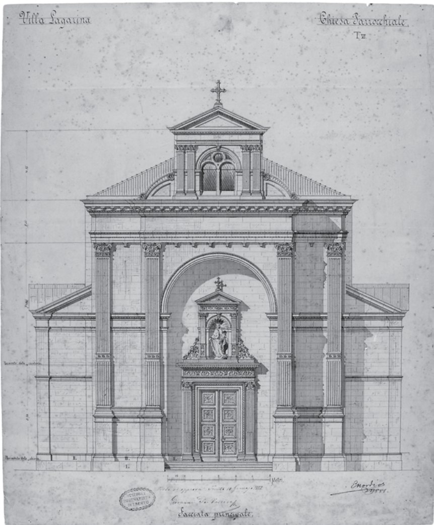
Fig. 28 - Enrico Nordio, «Villa Lagarina Chiesa Parrocchiale, T. VI, Facciata principale», progetto definitivo, scala 1:50, disegno autografo, 1881, timbro «Vescovile Ordinariato di Trento», approvazione «Giovanni Pr. Vescovo /pm», Trento 10 gennaio 1882 (Biblioteca Comunale - Villa Lagarina; FB).
